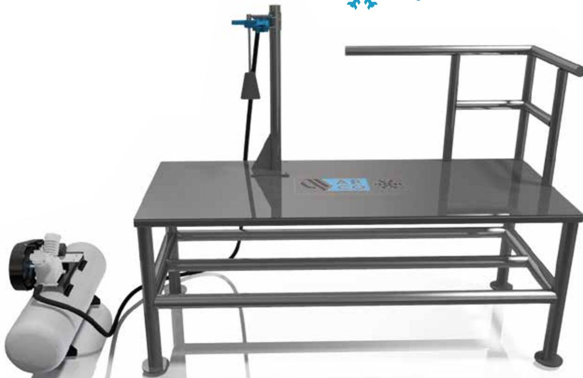
Mesa de acero inoxidable con base y soporte para pistola engrapadora neumática alimentada por un compresor y accionada por un balancín que realiza el sellado de las bolsas de hielo.
