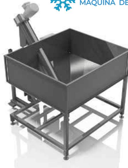
Fabricadas en acero inoxidable tipo 304, cuentan con un elevador helicoidal accionado por un pedal encargado de transportar el hielo a las bolsas, además de contar con soporte para colocar la bolsa y llenar de manera ágil.
